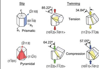
Exemple : mécanismes de déformation et d'orientation dans le zirconium.
